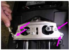
矢印の四カ所のボルトを外します。 タンデムキーシリンダー部分を外します。
