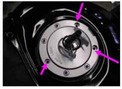
がソリンタンクを取り付け、タンクカバーを付ける前に。 タンクキャップを外します。写真のボルト三カ所を外し、 タンクキャップのキーロックを解除します。
