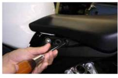
シートを外すため、写真のネジを外します。 左右とも外し、シートを外します。 また、タンデムシートも外します。
