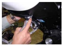
樹脂トレーを上げながらリヤタイヤ側から覗き込むと 写真のようにタンデムステップを止めるボルトが見えます。 ボルトを外してタンデムステップを外します。 (写真には試作モデルが付いています。)
