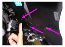
テールカウル下のリヤタイヤ側から見た写真。 写真の3つのネジを外し、黒い樹脂カバーを外します。 (写真には試作モデルが付いています。)
