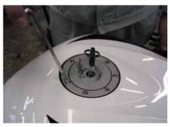
⑤ タンクカバーを取り付けた後にタンクキャップを付けます。 タンクキャップのボルトは M4 なので、 弱めのトルクで締めて下さい。
