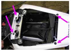
テールカウルを外します。 まず、左写真の矢印の四カ所のボルトを外します。
