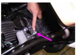
ガソリンタンクを止めている四つのボルトのうち、 前のボルトのみ左右を外します。
