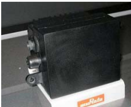
図 1 76GHz 帯ミリ波レーダ。外形寸法は 100mm×86mm×90mm
