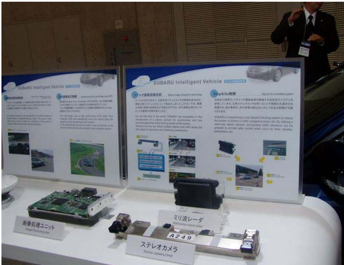
左からGPSアンテナ、画像処理ユニット・ステレオカメラ、ミリ波レーダ「日立製」(富士重)
