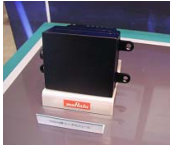
76GHz 帯のミリ波レーダ・モジュール
