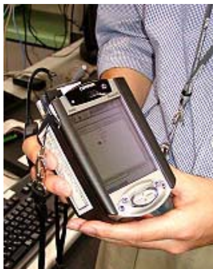
MIRAI の PDA タイプの実験機。見ての通り、装着された拡張スロットに、有線 LAN インターフェースをはじめ、無線 LAN や PHS などの通信カードが全部
