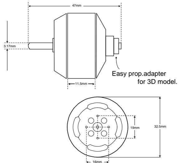
B / 12シリーズは、モーター本体がプロペラアダプター一体構造となっておりますので、プロペラアダプターとして使用する場合は、シャフト止めネジを交換してご使用ください。
