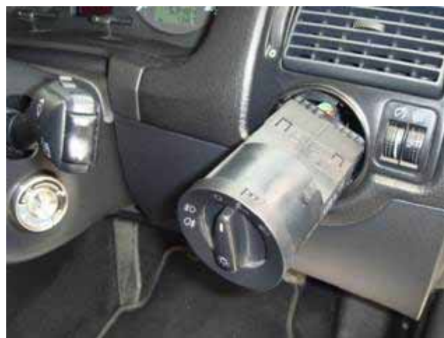
ヘッドライトスイッチを抜き出します。スイッチを押し込み右側に回すと引き出せます
