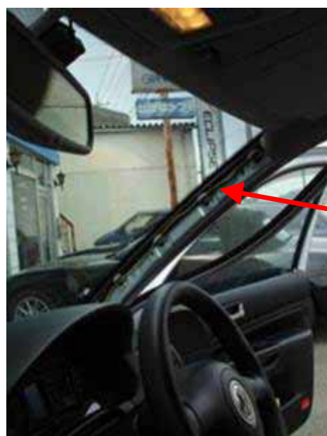
Aピラーの内張りを外し、黄色いコードをヒューズボックスまで導きます
