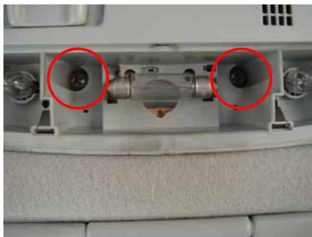
2箇所のプラスネジを外します
