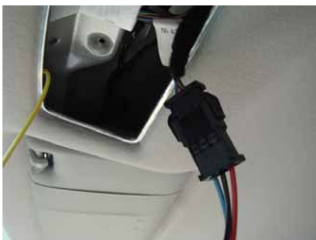
車両側のコネクタに付属のケーブルを差し込みます
