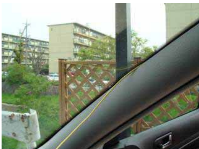
黄色いケーブルはフロントウインドウ側に引き出しておきます
