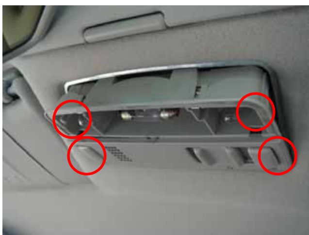
4箇所のつめを押し込みながらフロントガラス側から抜き出します
