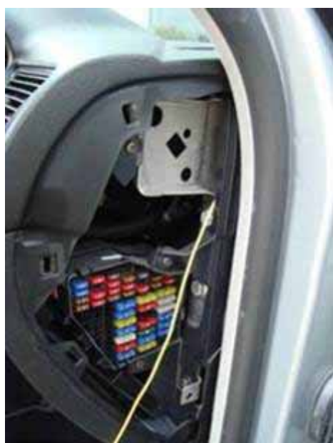
ヒューズボックスをヘラのようなものでこじ開けます。手前からこじるように開けるとカバーが外れます
