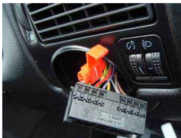
ライトコネクタの17番ケーブルに付属のカプラーで接続します
