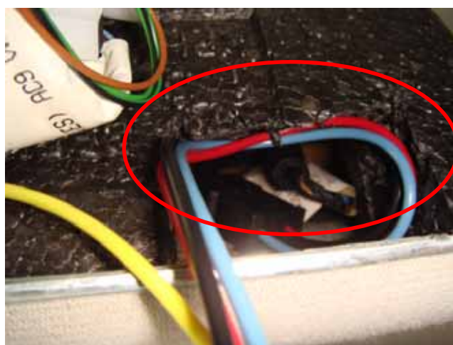
そのままではW8ランプのコネクタが入らないので黒い発泡スチロールをコネクタのサイズ分切り取ります。この際配線を切らないように注意してください。W8ランプははめ込み式なのでコネクタ側から差し込み、ぱちんとはめ込みます。
