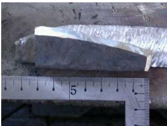
鍛接前の地金と鋼の様子
